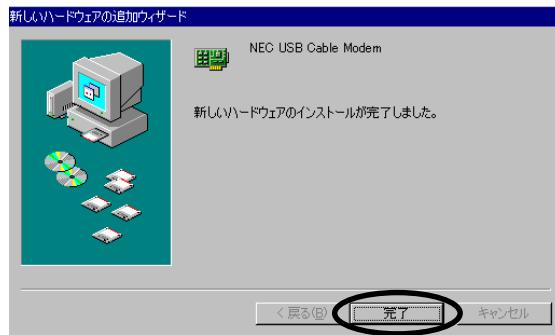
インストールが完了されない場合は、『戻る』を選択し『ドライバの場所を指定する (S)』を選択し、CD - ROM ドライブを検索してください。
